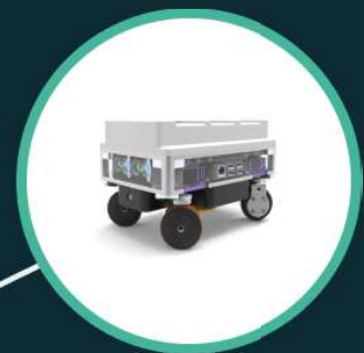
Vehicule ghidate autonom (AGV) pentru asigurarea fluxului de materiale între spațiile de lucru
